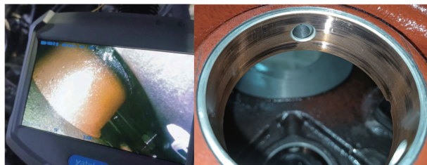
图 9 三角堵盖烧蚀、衬套磨损
