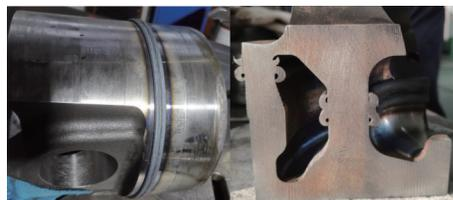
图1 一体式摩擦焊钢质活塞样件
