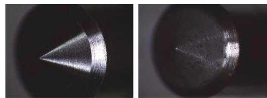
图5 针阀试验前后影像
