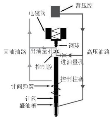
图1 电控喷油器工作原理图
