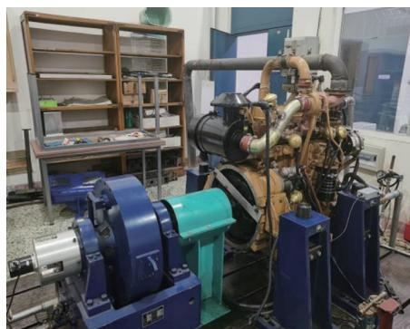
图2 柴油机试验台架
