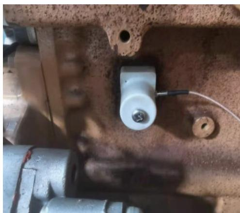
图3 声发射传感器安装实物图
