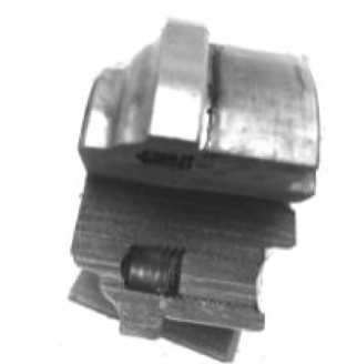
图 3 切割后的泵传动断裂螺钉
