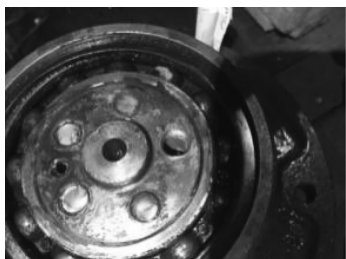
图 2 留在轴孔中的断裂螺栓
