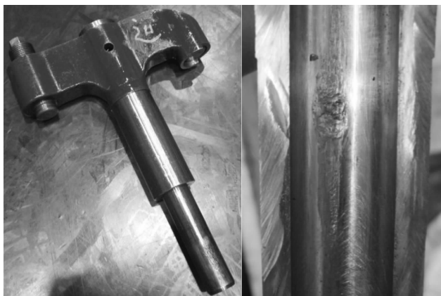
图 1 进气阀桥与阀桥导柱咬合情况
