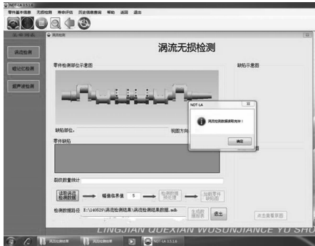
图 9 寿命评估软件读取涡流无损检测数值
