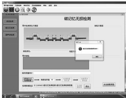
图 10 寿命评估软件读取磁记忆无损检测数值
