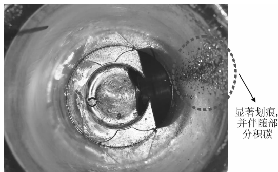
图1 柴油机气缸套内表面划痕
