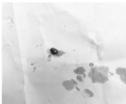
图2 柴油机润滑油喷嘴内硅胶块
