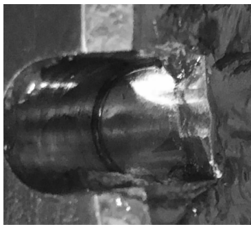
图2 齿轮定位面过压
