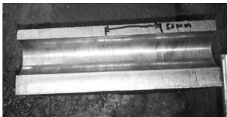
图 11 内冷铁残留缺陷
