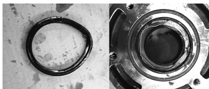
图4 水射密封环变形，油封内圈弹簧断裂
