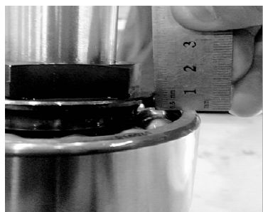
图2 轴承内圈与水泵轴发生轴向相对位移
