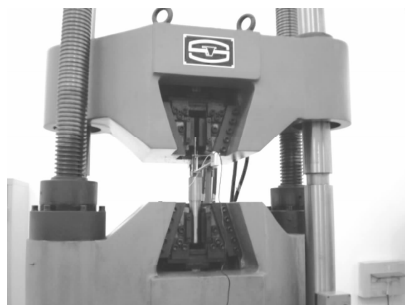
图3 螺栓夹紧在拉伸机上
