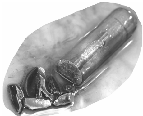
图5 损坏的挺柱与破碎颗粒
