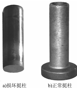
图3 损坏挺柱和正常挺柱对比
