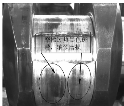
图 1 连杆瓦、连杆颈磨损情况
