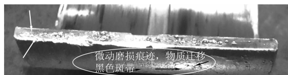
图6 瓦背瓦端面微动磨损情况
