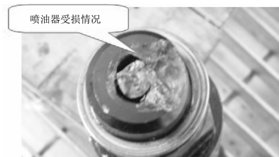
图4 A2 缸喷油器严重损坏
