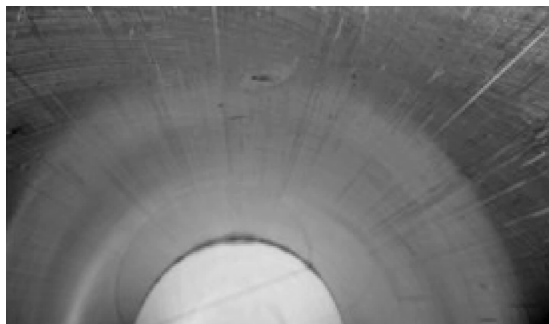
图3 A3 缸缸套内部有不同深度的拉痕
