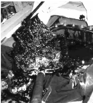
图 1 加装合规低硫燃油后油舱内产生大量颗粒状油泥
