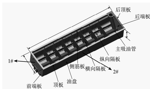
图2 油底壳原始结构和振动速度响应取点位置
