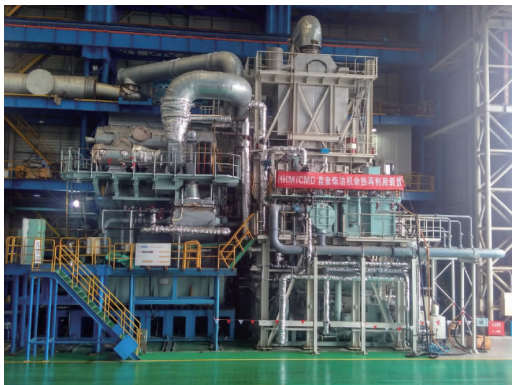
图 4 6S50ME-C8.2 柴油机余热利用装置
