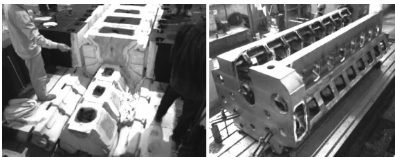
(a)生产试制 (b)试制完成的机体 图 10 生产试制及试制完成的机体
