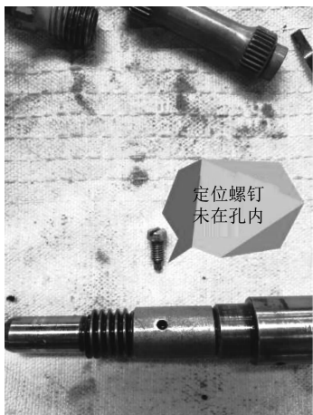
图5 定位螺钉掉出
