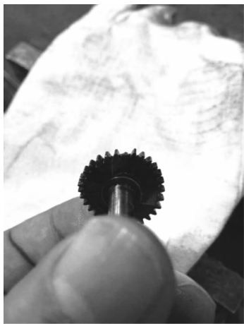
图6 传动齿轮一齿断裂
