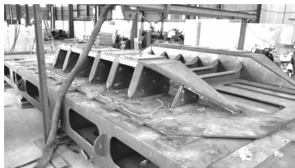
图5 阻尼基座减振效果试验
