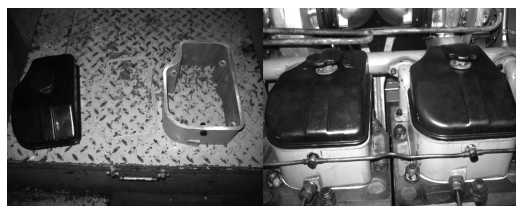
图 9 气缸盖下罩壳采用纸垫加胶的密封方式
