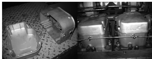
图 10 气缸盖下罩壳升级后密封方式
