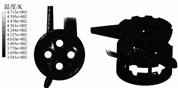
图 10 单缸水套温度分布
