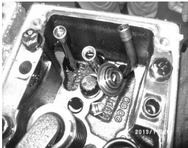
图 3 挺杆弯曲、气门锁夹脱落
