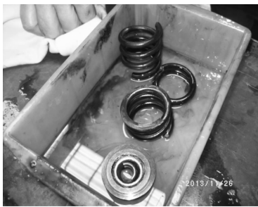
图 4 断裂的气门弹簧
