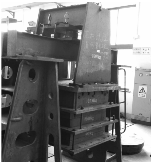
图 2 隔振器蠕变性能测试
