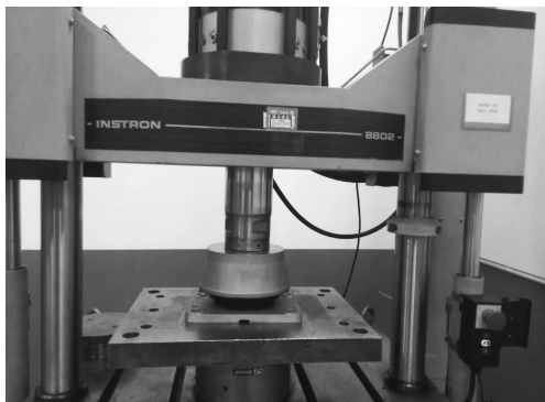
图 1 隔振器动、静态性能测试
