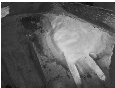
图 4 堆焊区域表面 PT 探伤
