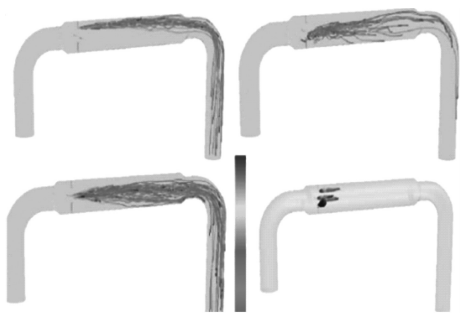
图 7 1 支 SU 空气辅助喷嘴喷雾羽流与运动轨迹
