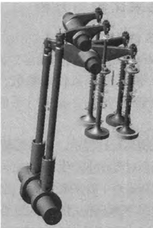
图 2 配气机构多刚体系统模型
