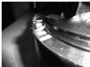
图 19 压壳未脱落, 转轴未伸出增压器
