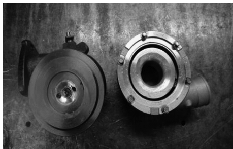
图 11 压壳和中间体连接处脱落
