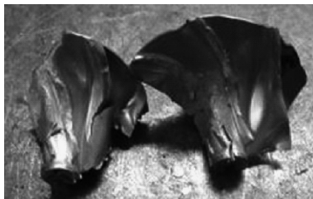
图 8 轮毂断裂成两半
