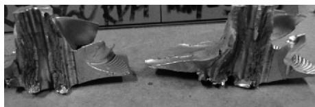
图 15 改进后试验中轮子分裂成两半
