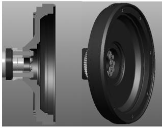
图1 曲轴与整体式飞轮螺栓压紧端面联结示意图
