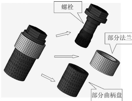
图 1 单个螺栓计算模型图
