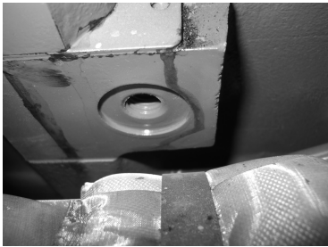
图 2 漏机油部位示意图
