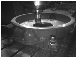
图 6 加工中心配备测量探头
