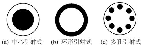
图 2 不同喷嘴类型引射器
