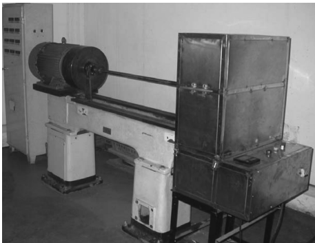
图 9 减振器扭振模拟台架
