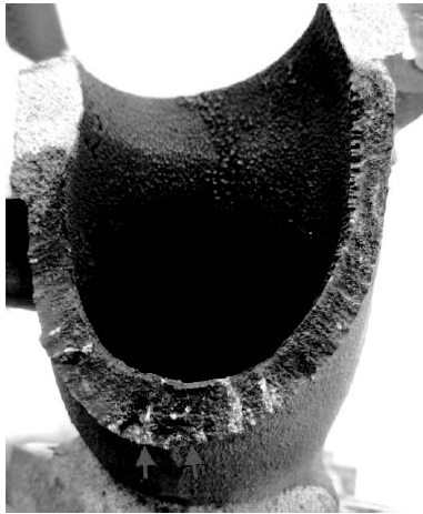
图 2 裂纹打开后断口宏观形貌
