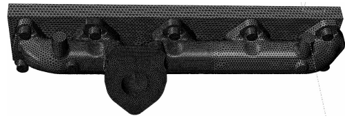
图 5 计算装配模型网格图
