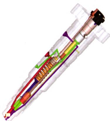
图4 液体燃料双喷嘴喷油器设计
