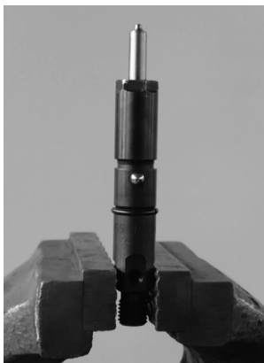
图 2 台虎钳倒立夹持喷油器
