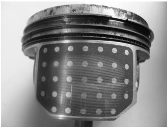
图 8 拉缸试验后活塞次推力侧
