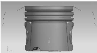
图 10 活塞型线(90°方向)放大 50 倍
