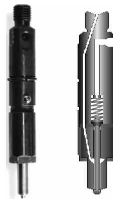
图 1 B 系列康明斯柴油机低惯量孔式喷油器
