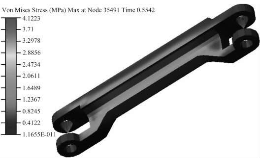
图 4 动力连杆应力云图
