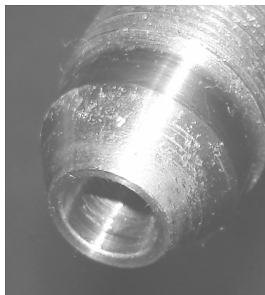
图1 从喷油器上拆下时的油管密封锥面
