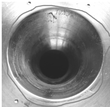
图4 喷油器压盖密封锥面
