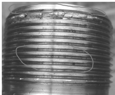
图3 喷油器压盖螺纹粘咬面
